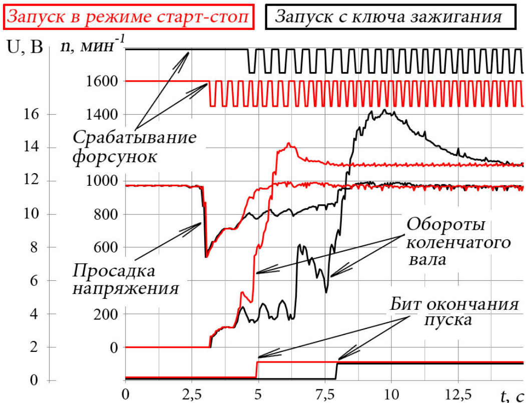
Рис. 2.32. Диаграммы реализации режима «быстрый пуск» для автомобиля с системой «Старт – Стоп» и без нее
