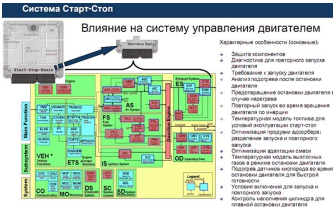
Рис. 2.30. Функции системы «Старт – Стоп», влияющие на работу ЭСУД
